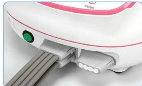
(Verbindung zwischen Hauptkörper und Manschette) (Luftschlauchverbindung zum Hauptkörper)
